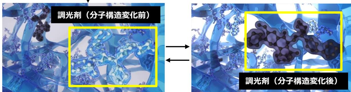
調光剤（フォトクロミック分子）は光が当たると分子構造が変化し色が濃くなり、光が引くと再び元の形と色に戻る。このような分子の性質により光に合わせてレンズの色が変化し、着用者の目に入る光の量が自動で調節される。
